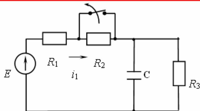
Дано:  $E = 120 \text{ В}$ ,  $R_1 = R_2 = 10 \text{ кОм}$ ,  $R_3 = 20 \text{ кОм}$ ,  $C = 10 \text{ мкФ}$ .
